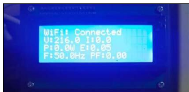
Gambar 14. Tampilan Data Monitoring pada LCD 20x4 I2C
