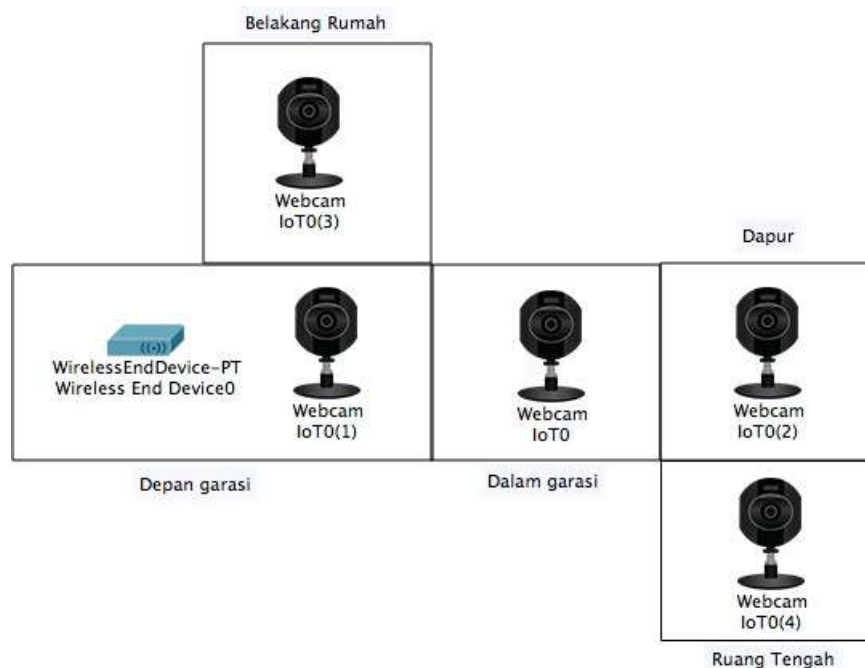
Gambar 1. Rancangan Pemasangan CCTV
