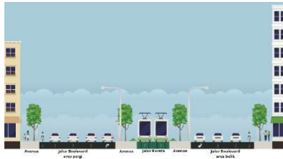
Gambar 11. Potongan Skematik penerapan Avenue melalui sampel Jalur Boulevard pada Prinsip Pola Penghijauan
