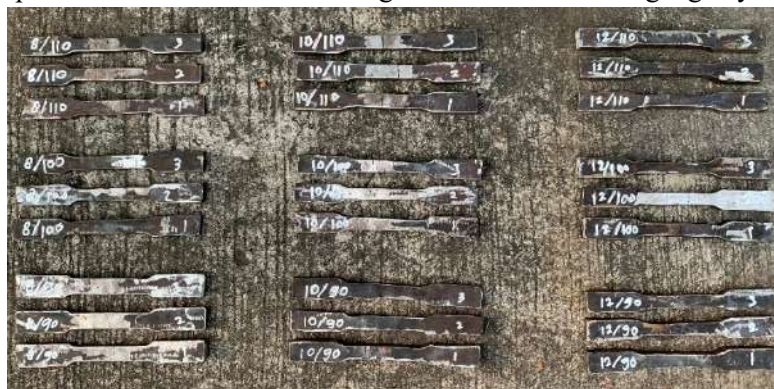
Gambar 2. Spesimen uji tarik (ASTM-E8)
