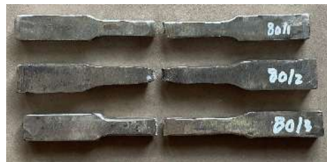
Gambar 16. Material hasil pengujian tarik ketebalan 10 mm (Arus 80 A) Sumber: Data Primer
