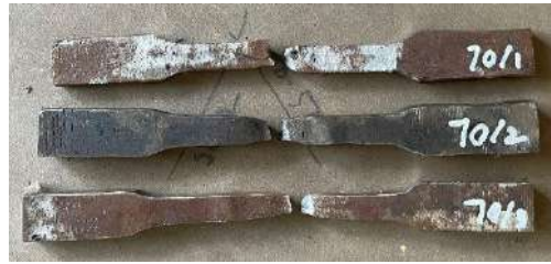
Gambar 15. Material hasil pengujian tarik ketebalan 10 (Arus 70 A) Sumber: Data Primer
