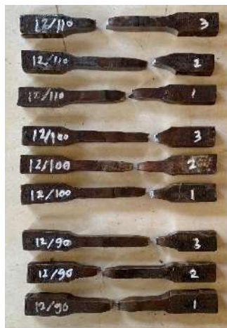
Gambar 14. Material hasil pengujian tarik ketebalan 12 Sumber: Data Primer
