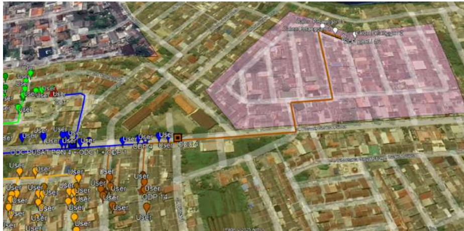
Gambar 13. Pemanfaatan jaringan yang sudah ada untuk pemasangan jaringan ke pelanggan baru di wilayah baru saat ini.
