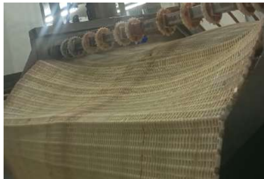
Gambar 5. Proses pelepasan modular dari mesin
