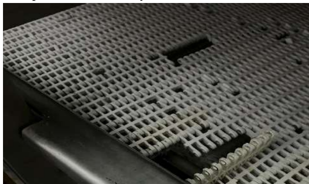
Gambar 3. perbaikan modular yang sobek
