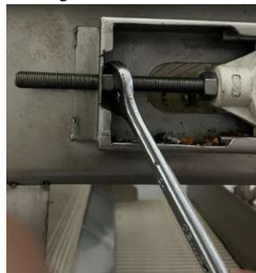
Gambar 1. Penyetelan adjuster conveyor
