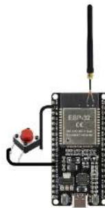
Gambar 2. Skema Rangkaian Elektronika Sistem dengan Modifikasi Antena dan Tombol Reset
