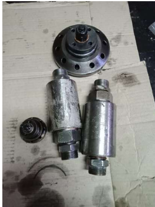
Gambar 2. Komponen katup Main Air Compressor setelah pembongkaran
