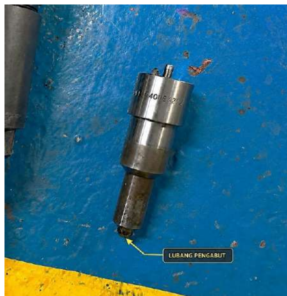
Gambar 2. Lubang Pengabut Nozzle Injektor yang Kotor
