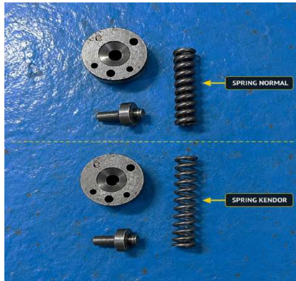
Gambar 3. Spring Injector yang Melemah
