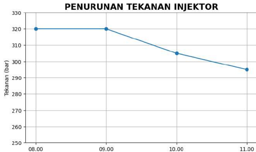
Gambar 1. Grafik Penurunan Tekanan Injektor
