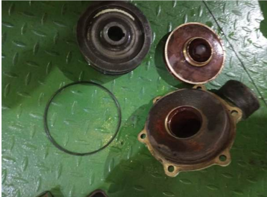
Gambar 4. Komponen Pompa yang Mengalami Korosi dan Keausan
