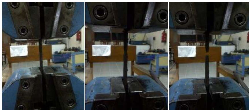
Gambar 6. Uji Tarik Spesimen I
