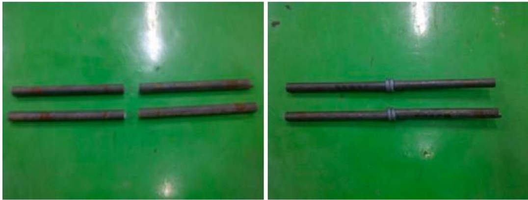
Gambar 5. Spesimen III, IV yang Telah Dilas
